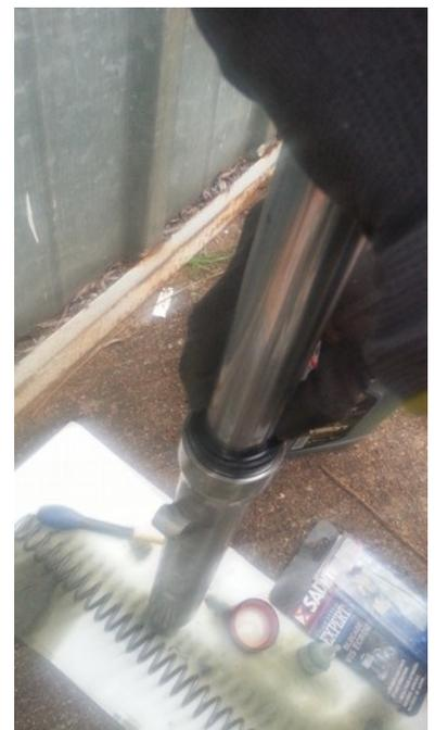
Pour positionner correctement le joint spy sans l'abîmer, voici une astuce : utiliser un tube PVC de Ø50 mm. Se servir du coté « d'usine » sur le joint spy (coupe nette). Le tube s'adapte parfaitement sur le bord extérieur du joint spy. On peut ainsi « frapper » sur le tube pvc pour renter le joint spy correctement. Il est en position, lorsque l'on voit la gorge de réception du jonc de maintien.
