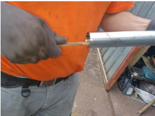
*Nettoyage de l'intérieur du tube plongeur*
