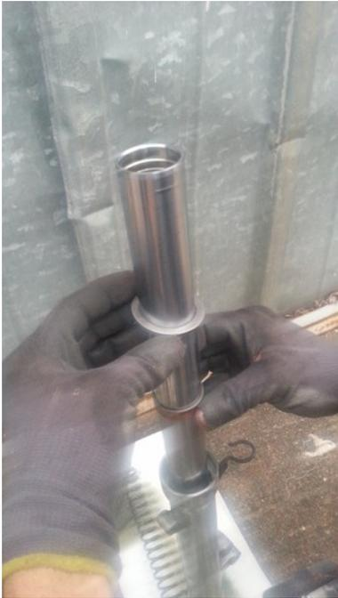
Graisser le nouveau joint psy avec de l'huile de fourche. L'insérer bien à « plat » sur le tube plongeur.
