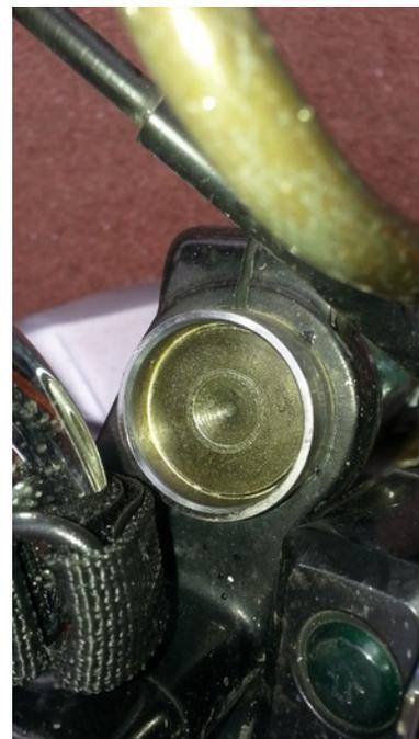
Libérer le circlips (abus de langage, c'est un « anneau expansif », appelé « jonc de calage » sur la RMT). Pour cela utiliser une rallonge de clé à cliquet (carré moyen). Cette dernière se cale pile dans le creux du bouchon de tête de fourche.
