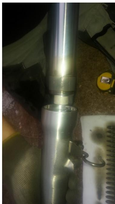
Pour ré-assembler la vis hexacave de fixation de la pipe, nous allons nous servir du ressort principal pour « pousser » et maintenir la pipe dans le fond du fourreau. Le ressort va nous permettre de serrer cette vis sans que la pipe tourne sur elle-même.
