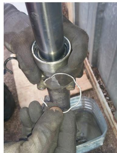
Retourner l'amortisseur – **Attention** : mettre sa main sur le haut du bras avant de le retourner ... « ça dégringole ».
